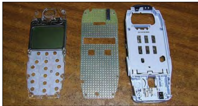
La placa de circuito impreso de islotes troquelada para ser utilizada con la caja del teléfono.
