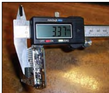
El espacio dentro de la caja del teléfono es igual al de su placa de circuito impreso: 3.3 milímetros de altura.
