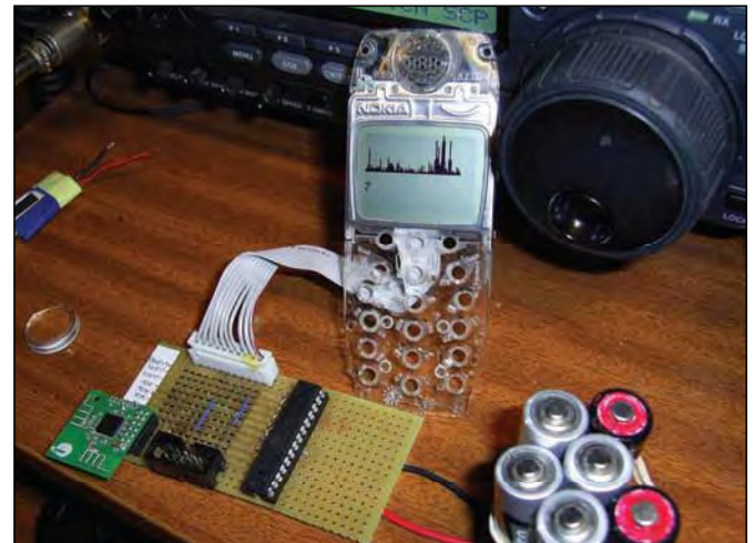
El prototipo mostrando la presencia de la señal de una cámara inalámbrica en 2468 MHz.
