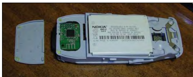
El analizador funcionando, vista trasera a falta de colocar la tapa del hueco de la antena, donde se puede apreciar el módulo transceptor de 2.4 GHz.
