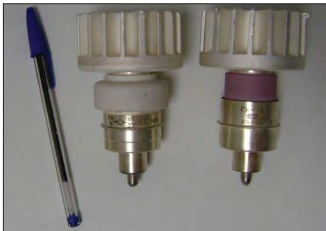
FOTO 1: Comparativa de tamaño triodos GI-7B y GI-7BT
