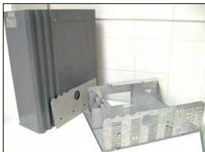
FOTO 6: Chasis del amplificador.
