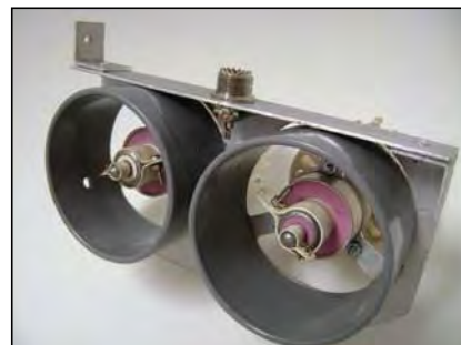
FOTO 9: Soporte de los triodos vista trasera.
