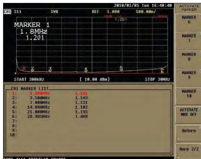
Figura 2: Gráfica del comportamiento del UNUN 9:1 cargado con 450 W
