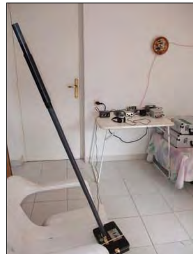
Fotografía de instalación interior. En primer plano la antena vertical con la bobina. Al fondo el equipo QRP y el principio del hilo de 5 m de longitud extendido en la pared.
