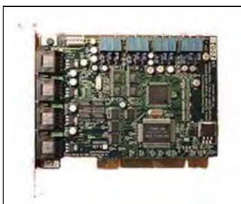
Tarjeta Quad PCI capaz de controlar 4 equipos de radio e interactuar con el módulo app_rpt de Asterisk
