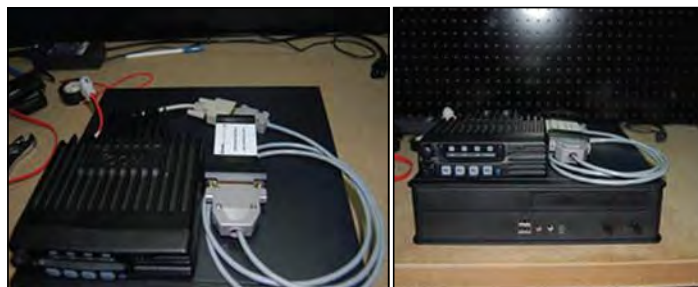
Se puede observar un equipo de radio que será el encargado de captar las señales radio y mediante el uso de un interface URI (Universal radio Interface) hacemos llegar las señales radio al PC por USB. Una vez dentro el PC con S.O GNU/Linux y Asterisk trata la señal y la convierte mediante códecs en VoIP que puede ser transportada por una red IP (red HSMNN)
