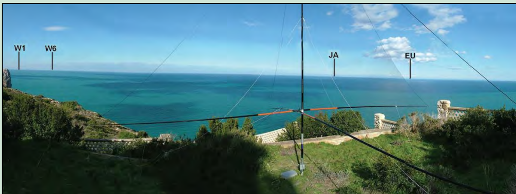
Vista panorámica con los principales rumbos que se iban a cubrir con el lóbulo principal de la antena. En primer plano la antena K9AY de recepción y conmutable para 4 direcciones.
