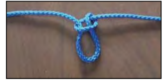
Figura 8b: Se forma una gaza pasando el firme por el interior del lazo.
