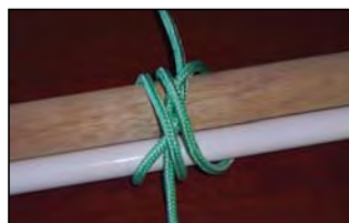
Figura 4c.- Si se desea se puede dar una tercera vuelta para mayor firmeza.
