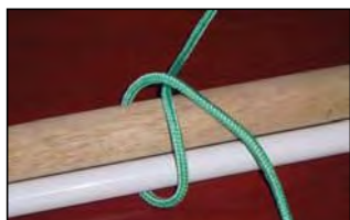
Figura 4a.- Boca de saco o constrictor: Se da una vuelta completa a las dos piezas a unir.
