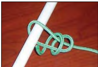
Figura 7a.- Nudo de ocho corredizo: Se pasa el cabo alrededor del punto al que se desea atar dando el chicote dos vueltas completas alrededor del firme.
