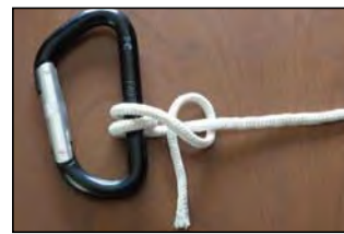
Figura 5b.- El chicote realiza un cote sobre el firme.
