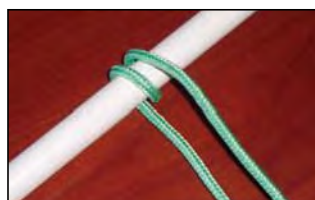
Figura 6a.- Vuelta de pescador: Se dan dos vueltas sobre el punto sobre el que se desea amarrar.
