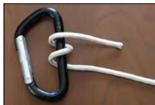
Figura 5a.- Vuelta de rezón. Se dan dos vueltas sobre el punto de amarrar.
