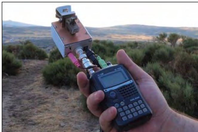
Figura 13: Walkieceptor de 24 GHz. La versión portátil del transceptor de 24 GHz.
