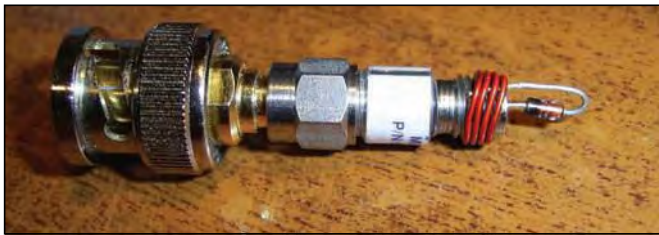
Figura 10: Generador de armónicos, consistente en un atenuador SMA de 10 dB y un diodo 1N4148.
