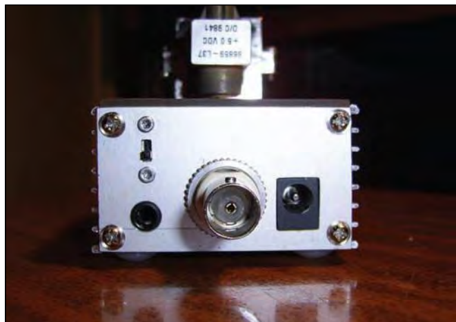
Figura 7: Vista posterior de uno de los transceptores. Se puede observar la conexión de micrófono (izquierda) la salida de frecuencia intermedia (centro) y la entrada de alimentación (derecha). El pequeño interruptor deslizante activa el oscilador de doble tono.
