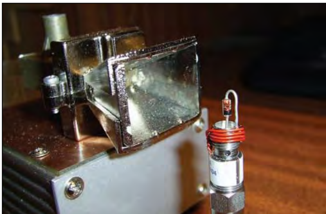
Figura 11: Situación del generador de armónicos delante de la cavidad para proceder a los ajustes de frecuencia.
