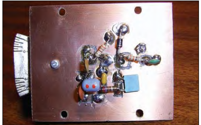
Figura 4: Para la realización de la parte de radiofrecuencia se ha utilizado una placa de circuito impreso virgen a la cual se le han realizado una serie de topos para realizar las conexiones de los diferentes componentes.
