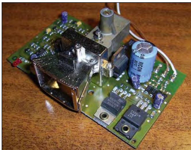
Figura 1: Módulo Doppler en 24 GHz, utilizado en sensores de movimiento.
