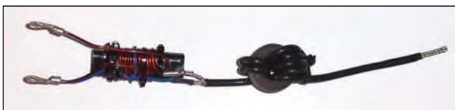
Balun y choque terminados
