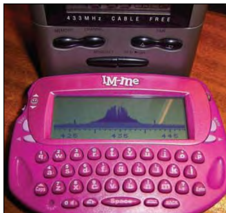
Figura 9: Vista panorámica del ruido generado por el receptor superregenerativo de una estación meteorológica en la banda de 70 cm.
