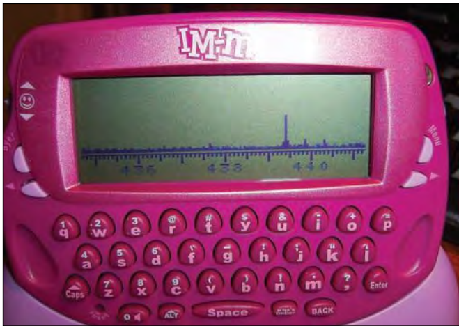
Figura 7: Vista panorámica de la parte superior de la banda de 70 cm. La señal que se aprecia en 439.4 MHz es el repetidor ED4YAB.
