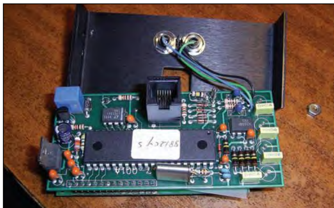
Imagen 5: Aspecto interno del monitor de antena.
