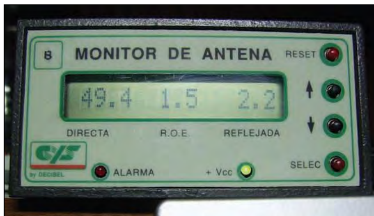
Imagen 7: El monitor de antenna en acción: potencia directa 49.4 vatios, potencia reflejada 2.2 vatios, relación de ondas estacionarias igual a 1.5
