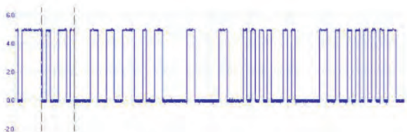
Señal real capturada en RB3 del PIC2 con el osciloscopio, podemos ver como se combinan los dos tonos para transmitir la señal.
