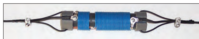
Bobina terminada y conectada a la antena.
