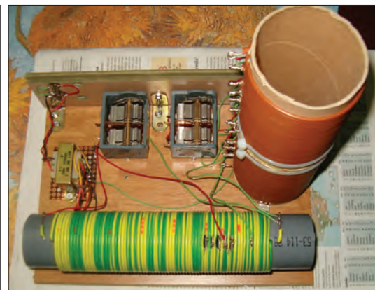
Foto 3: Vista montaje Rx con L1 y L2
