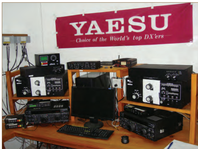
Fotos 5 y 6.- Estación de CU2X "single operator-2radios" y conexiones y conmutadores de coaxiales para las diferentes antenas
