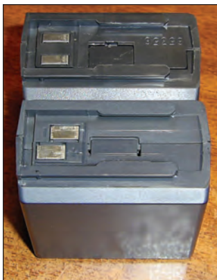
Imagen 2: La diferente disposición de los contactos en el portapilas Yaesu FBA-17 (abajo) impide que pueda ser cargado con el alimentador PA-6.
