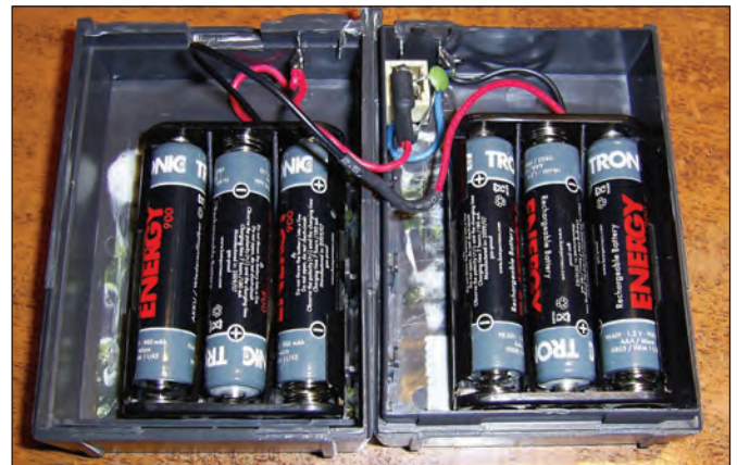
Imagen 1: Ejemplo de batería reconstruida. En una FNB-12 se ha colocado un par de portapilas, que permiten usar el walkie bien con pilas, o bien con baterías AAA de NiMH.
