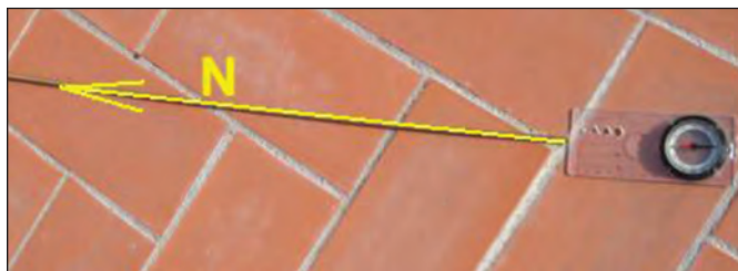
Colocar trípode sobre la brújula y regular el indicador de grados a cero dirección norte "N".
