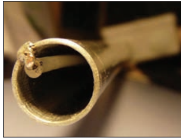
Extremo del coaxial en el tubo del dipolo
