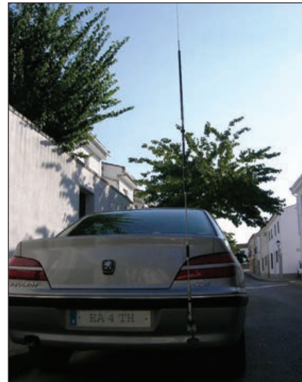
Foto 8.- Vista trasera del conjunto completo en configuración de 80 m. El conjunto queda discreto y no impide la visualización de los pilotos del coche.
