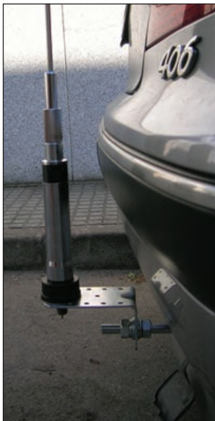
Foto 6.- Vista lateral con el soporte colocado y la antena en su sitio. Falta aquí conectar el cable RG-58.
