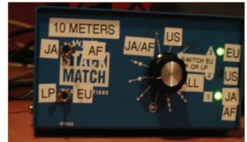
Foto 6b: Conmutador de antenas de la HC8N
