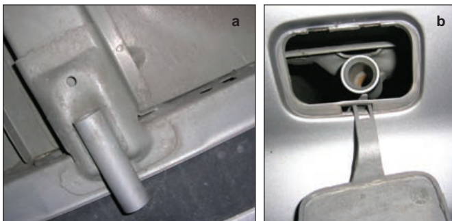
Foto 1.- a) Vista desde abajo del vehículo donde se observa la parte fija al chasis del enganche de remolque. b) Desde la parte exterior del vehículo con la trampilla bajada.
