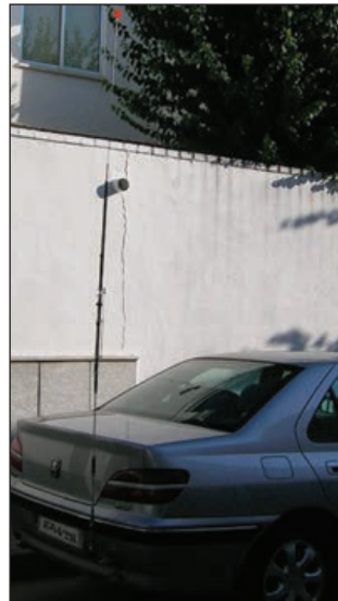
Foto 7.- Antena montada sobre el vehículo con el nuevo soporte en configuración de 80 m (2,40 metros). Obsérvese el punto rojo del final de la varilla.
