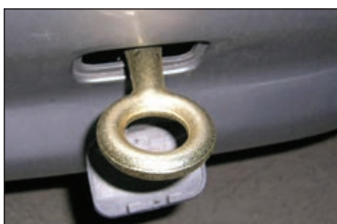
Foto 2.- Desde la parte exterior del vehículo con el gancho de remolque colocado, este es el aspecto que presenta.
