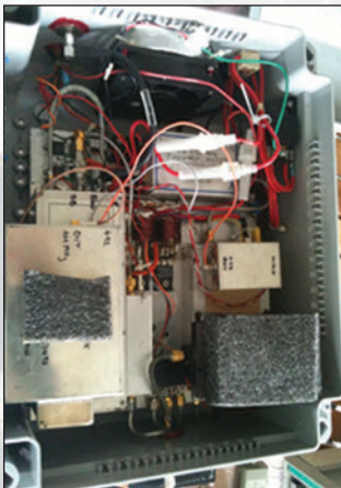
Detalle del transverter 5,7 GHz
