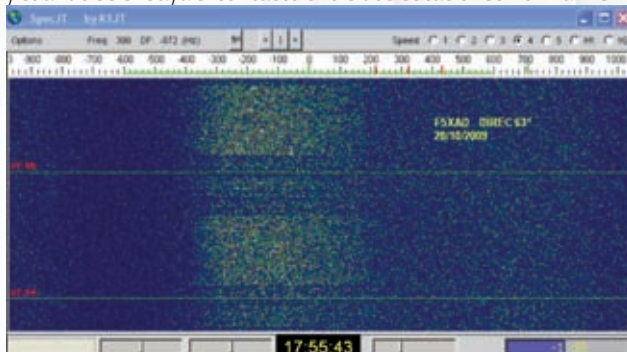
Espectro, vía tormenta, de la baliza F5XAD/B 10368.860 MHz. El ancho de banda por distorsión del efecto RS es de unos 500 Hz
