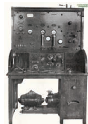
Primitivo emisor de Radio Ibérica que inició el Servicio de Radiodifusión en Madrid (H o de la Radiodifusión en España – Virgilio Soria, 1935)
