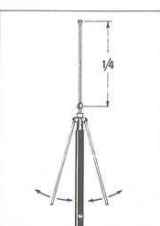
Figura 8.- Para reducir las ondas estacionarias en éste tipo de antena, se variará la inclinación de los radios hasta conseguir el mínimo de ondas estacionarias.
