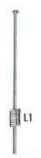
Figura 9.- Para conseguir el mínimo de estacionarias en éste tipo de antena, únicamente es necesario ampliar o reducir el número de espiras de la bobina de carga.
