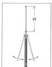
Figura 8.- Para reducir las ondas estacionarias en éste tipo de antena, se variará la inclinación de los radios hasta conseguir el mínimo de ondas estacionarias.
