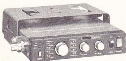
Programación a diodos 8 canales,
