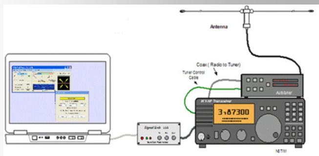
La configuración más común para los operadores de radioaficionados es usar una PC o computadora portátil, con el cliente Winlink Express instalado, y una interfaz de tarjeta de sonido como un Signalink USB o Rigblaster, conectado a su transceptor de HF. Esto es familiar para cualquiera que use modos digitales de banda estrecha o de bajo consumo con programas como FLDigi o WSJT-X. Vea el
