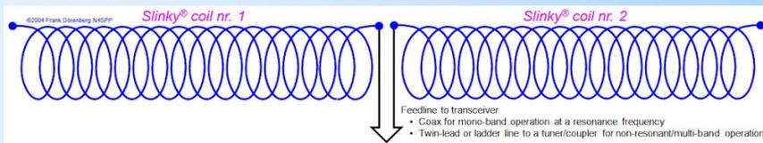
Una bobina Slinky estándar resuena como un cuarto de onda entre 7 y 8 MHz, cuando se estira a una longitud de entre 5 y 15 pies. Se pueden
