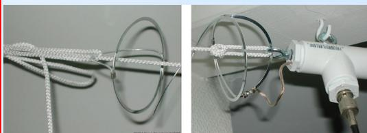
*Algunos detalles de construcción de mi primer dipolo Slinky*
