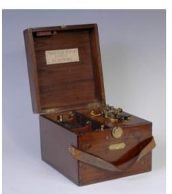
Transmisor radiotelegráfico de chispa para avión *Marconi* fabricado en 1912. 40 W.
