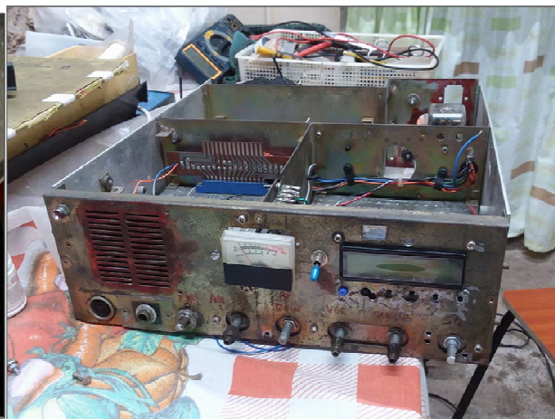
Metro de "S" y DDS insertados en el sub panel frontal.
