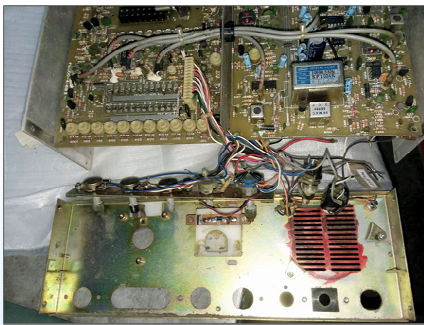
Proceso de desensamble del frente antes de hacer el hueco para el DDS.
