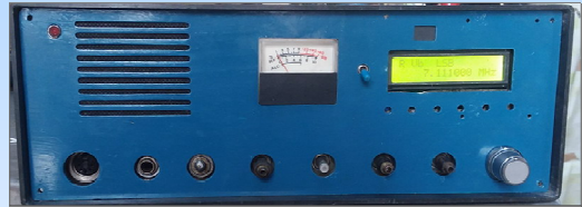
Frente medianamente terminado. Faltan todos los botones, perillas y el interruptor USB/LSB
