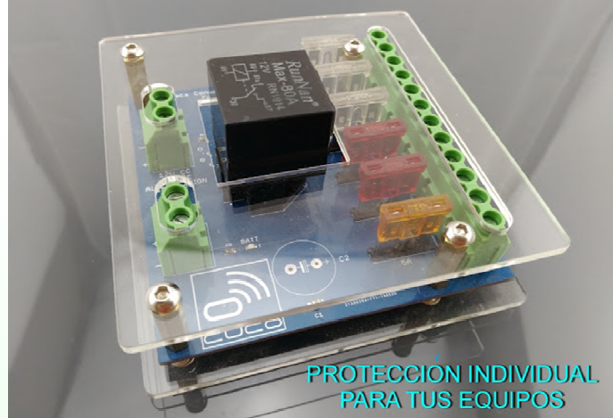
PLACA DE CONTROL ELECTRICO ESTACION BASE
