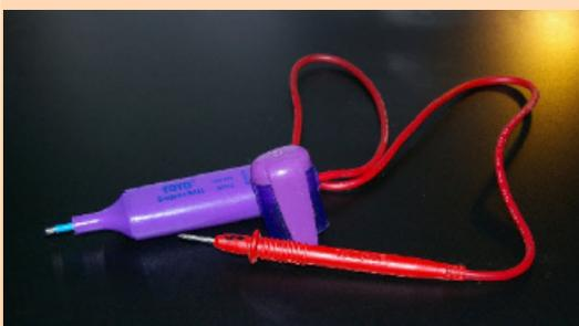
Descargador de condensadores acabado
