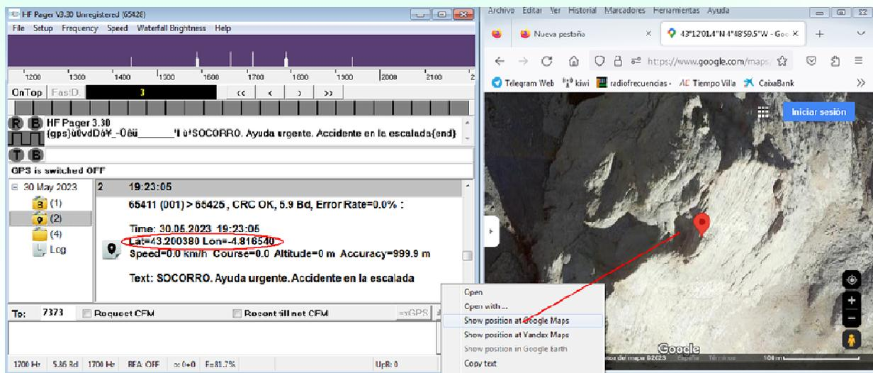
Baliza simulada por accidente en el Naranjo de Bulnes. La baliza se repite cada 5 minutos mientras dure la batería de los equipos.
