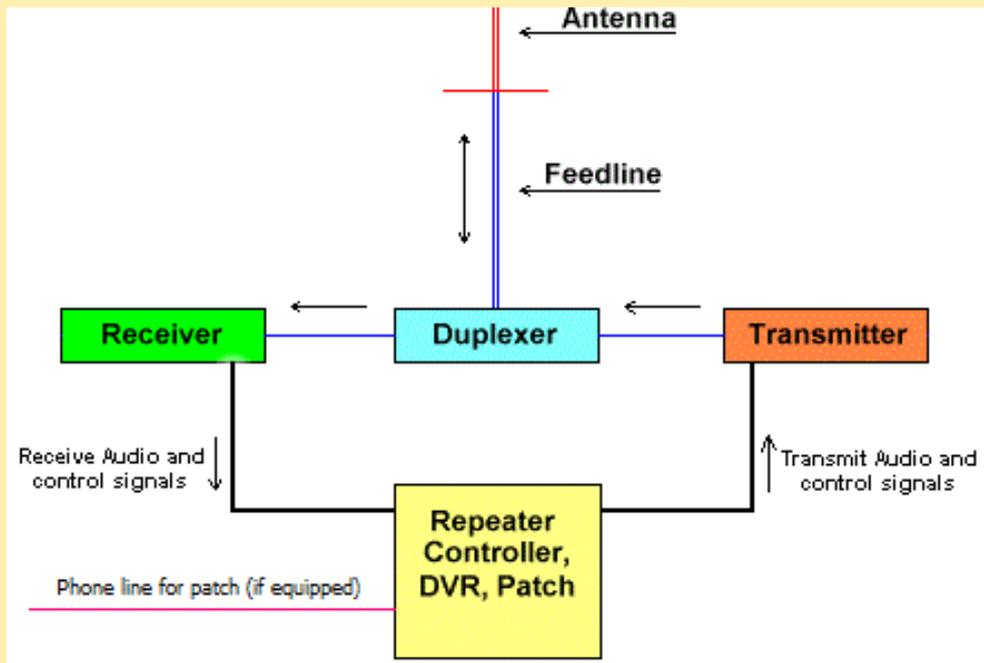
nal. Aquí hay un diagrama de bloques simple de un repetidor:
