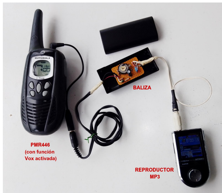
Baliza Vox ensayada por el autor. Corresponde al esquema anterior
