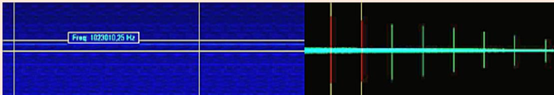
La velocidad de modulación resultante es de 1023000 chips por s. ( $50 \times 20460$ )
