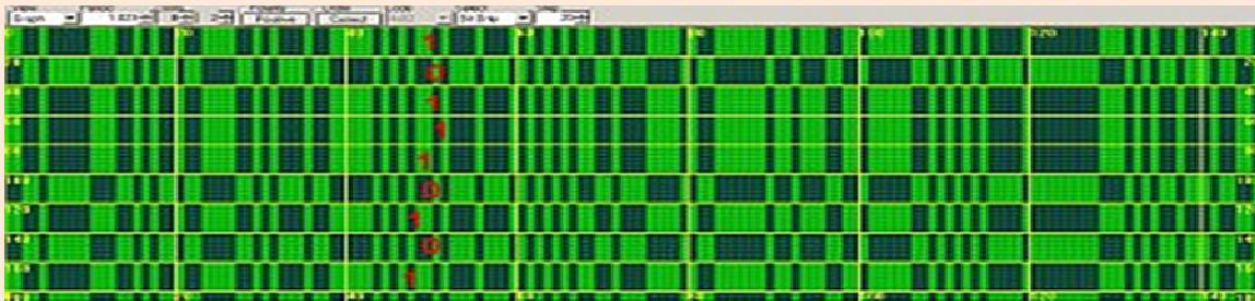
Una vez demodulada la señal se puede observar que cada bit original se transmite usando 20 secuencias PN completas (20460 bits). Si el bit cambia, la secuencia PN se invierte.
