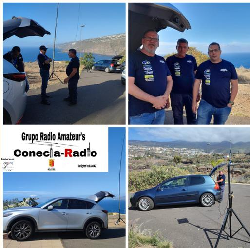
Una vez montada las diferentes antenas y equipos ( para HF, SotaBeam dipolo hilo para 20m y 40m) y para VHF (antena bibanda 1/4 de onda) Equipos de trabajo, la ICOM IC-706 MKIIG y un sencillo bibanda para trabajar local un Dinascan VHF-UHF (Móvil).
