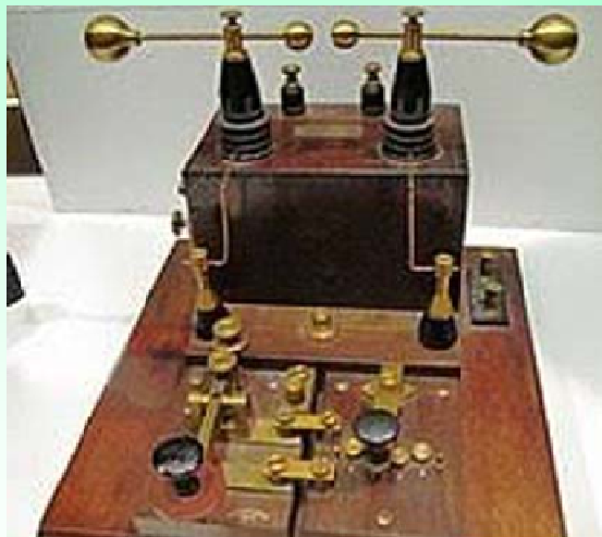
Un transmisor de chispa utiliza un arco eléctrico para generar una radiación electromagnética de radiofrecuencia que puede ser utilizada como transmisores para comunicación inalámbrica.
